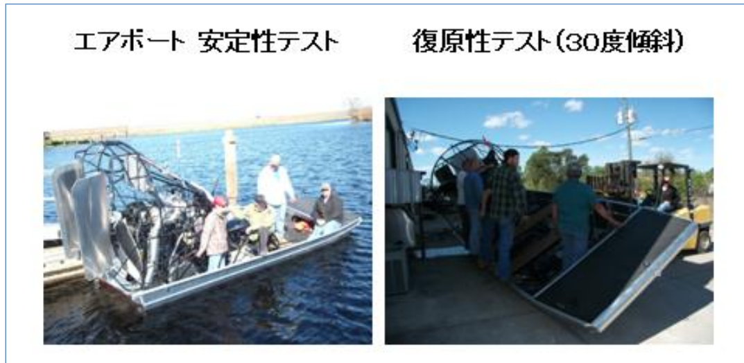
ボート航行に必要な 30 度傾斜安定試験にも合格、横波にも対処
