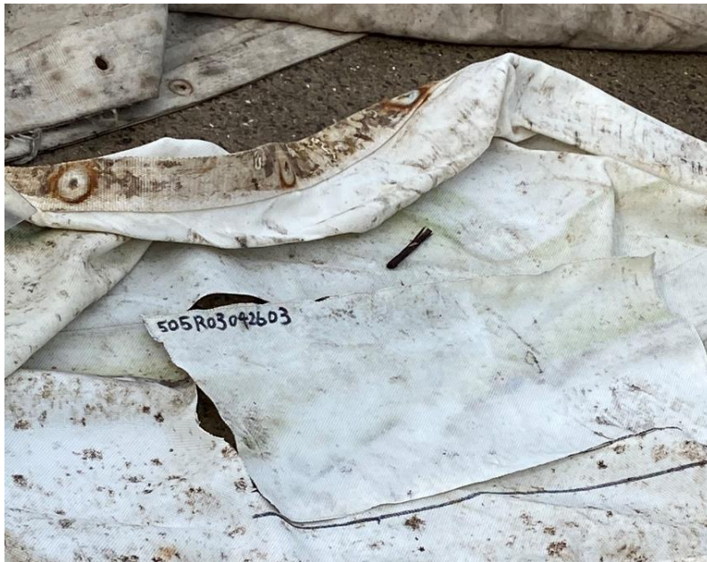
カーテン残存強度確認 試験供試体
