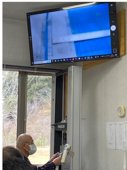
カーテン残存強度確認 引張試験状況
