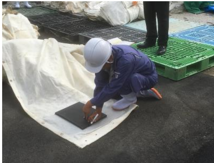
カーテン残存強度確認 試験供試体採取状況
