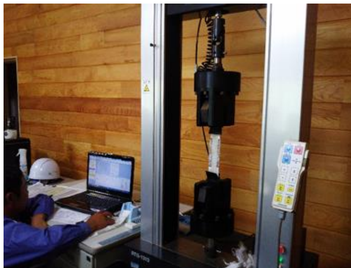
カーテン残存強度確認 引張試験状況
