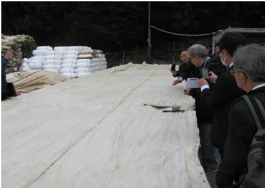
カーテン残存強度確認 ・ 試料採取状況
