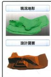
3次元測量データ(現況状況)と設計図面との差分から、施工量(浚渫土量、埋立土量等)を自動算出。
